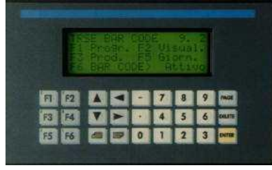
شكل (2.11): شكل وحدة HMI
