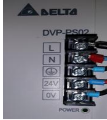
شكل(2.7): وحدة مصدر الطاقة ملحق لجهاز المتحكم المنطقي القابل للبرمجة (موديول).
